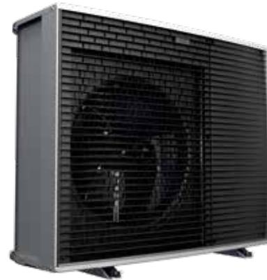
La unidad exterior contiene **refrigerante R290**, que pertenece a la "Clase de seguridad A3" definida en la norma ISO817 y utilizada en la norma EN378. Esto significa que debe cumplir **requisitos adicionales** del lugar de instalación ("zona de protección") para garantizar la seguridad en el improbable caso de que se produzca una fuga de refrigerante.
